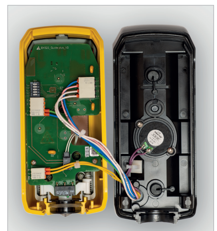
Die Stromversorgung erfolgt aus der Akustik.
