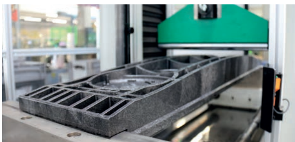
▲ 3-Punkt-Prüfpresse bei Langmatz in Oberau
