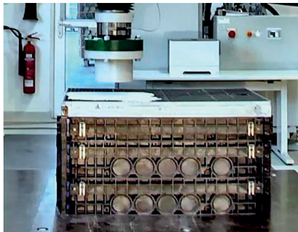
▲ Prüfung der Belastungsklasse bei Langmatz in Garmisch-Partenkirchen
