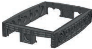
Rahmen 220 mm überbaubar Art.-Nr.: 06 508 0049E 2 x Rechteck / 1 x Ø 110 6 x Ø 110 / 2 x Ø 160 Gewicht: 27,0 kg
