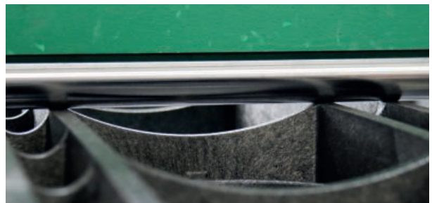
▲ Alle 2 Stunden regelmäßige 3-Punkt-Biegeprüfung
