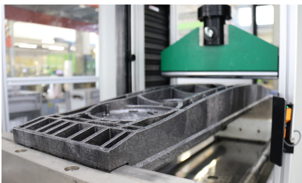
▲ 3-Punkt-Prüfpresse bei Langmatz in Oberau
