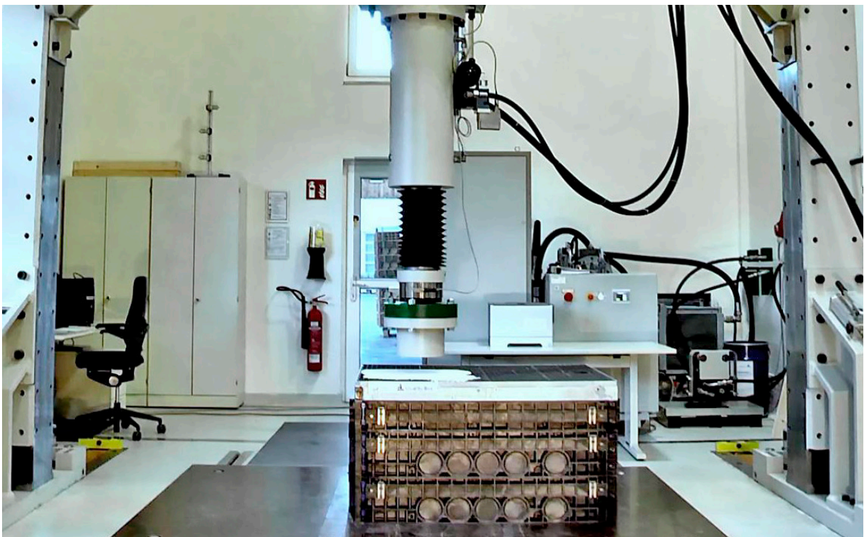
▲ Prüfung der Belastungsklasse bei Langmatz in Garmisch-Partenkirchen
